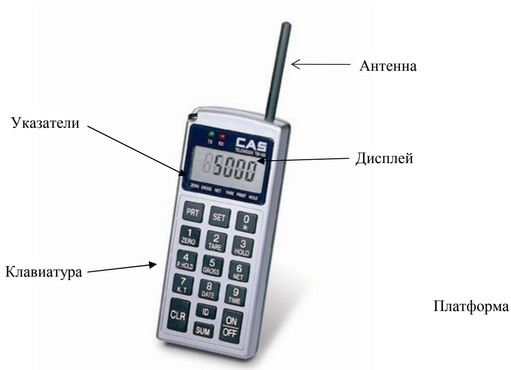
Рисунок 4.1 – Общий вид весов, основные элементы
